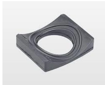
Satteldichtung Einlegen Diese muss der richtigen Dimension des Rohrs entsprechen (DN) und den richtigen Innendurchmesser der Schelle haben!
