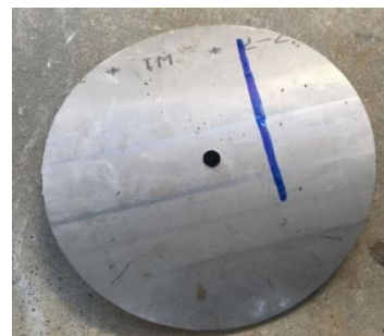
Bohrkern \varnothing 146 mm von einer V2A Leitung DN 250
