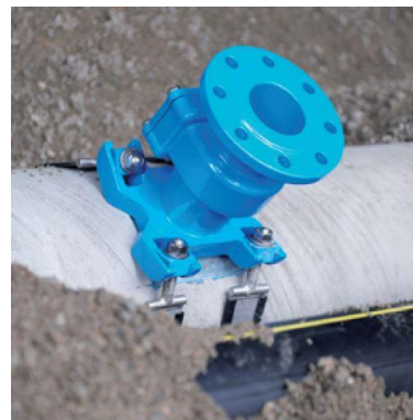
Flanschen-Anbohrschelle mit Steckscheibe DN 80 Bohrung bis max. Ø 75 mm möglich
