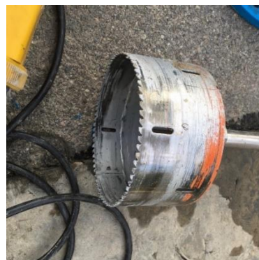
Verlängerter \varnothing 126 mm Kronenbohrer für Stahl- und Gussrohre mit Zementmörtelbeschichtung
