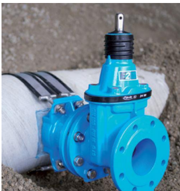
Anbohrschelle mit Schieber DN 80 – 150 Bohrung von Ø 78 mm bis 146 mm
