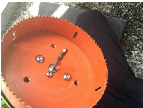
Kronenbohrer \varnothing 144 mm für Stahl- und Gussrohre mit Zentrierbohrer mit Spannring; dieser hält den Bohrkern fest und sichert ihn vor dem Herausfallen.
