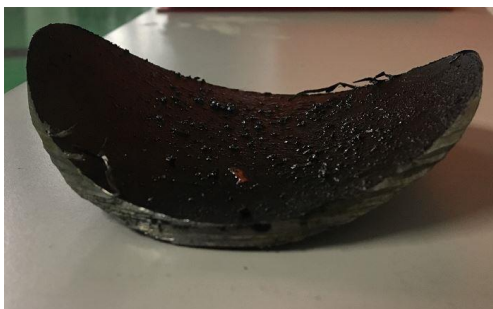
Bohrkern \varnothing 126 mm von einer Stahlleitung DN 150
