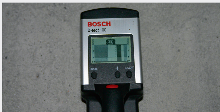
Fig. 8 Überprüfung der Bewehrungsüberdeckung nach dem Ausschalen der Betonoberflächen.
