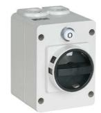
Für kleinere Verbraucher (Ventile, Elektroschieber, kleine Dosierpumpen etc.) können Steckverbindungen die Funktion der Sicherheitsschaltung übernehmen. Gemäss den Vorschriften gelten als Voraussetzungen: Nennströme kleiner 16 A und Gesamtleistung kleiner 3 kW. Der Sicherheitsschalter muss leicht und gefahrlos zugänglich sein und mit Sicht auf das einzuschaltende System gefahrlos betätigt werden können.
