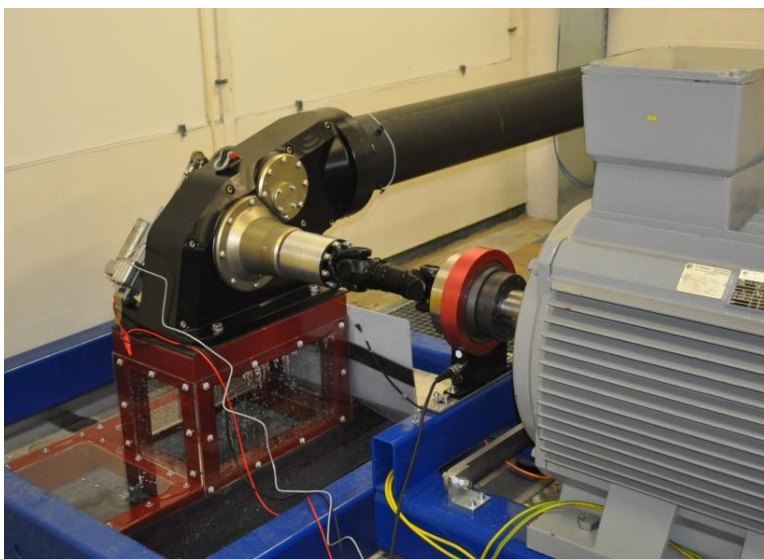
SIGRIST Cross Flow T16 auf dem Prüfstand
