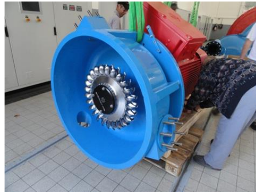
Turbine mit Laufwerk, Gehäuse Ø 1'000mm
