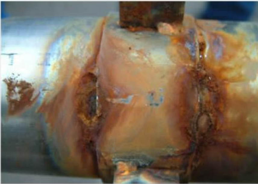
Korrosion an Heftschweißungen von Abstandshaltern in der Wasserkammer eines Spiralrohrwärmetauschers
