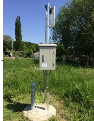
Station de mesure autonome - piézomètre Schaffhausen
